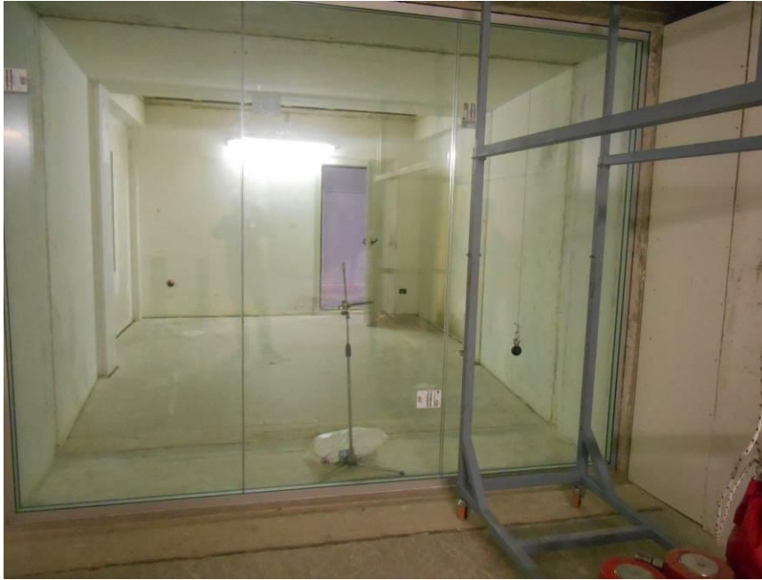
Dettaglio prova di resistenza agli urti da corpo duro
