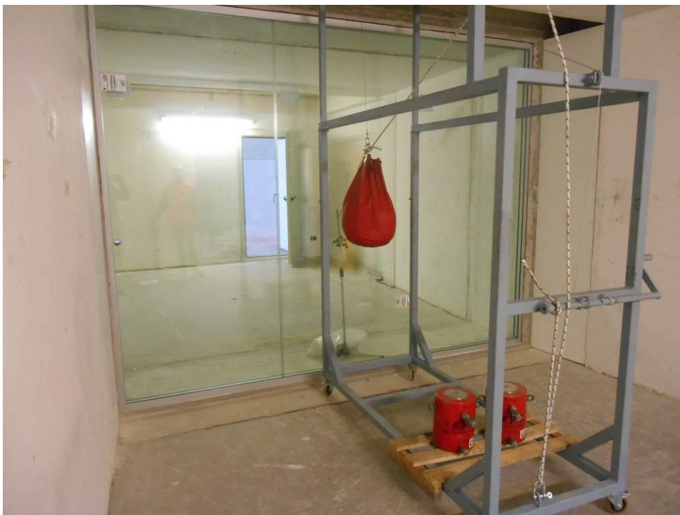
Dettaglio prova di resistenza agli urti da corpo molle
